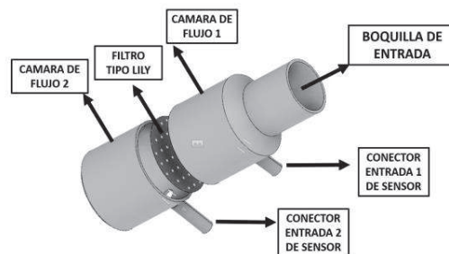
Figura 6 - Diseño realizado en el programa Fusion 360 para el espirómetro. Cuenta con 2 cámaras separadas por un filtro tipo lilly.
